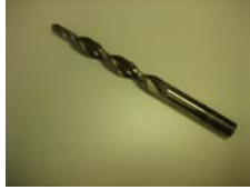
Borr \varnothing 5 mm och försänkare 10 mm
